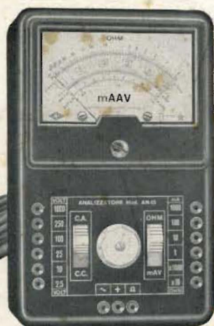
ANALIZZATORE TASCABILE Mod. AN 16 = 2000 \Omega p.v.
