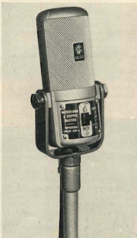
Microfono a doppio nastro, con risposta lineare tra 30 e 13.000 Hz. Impedenza di uscita 250 ohm.
