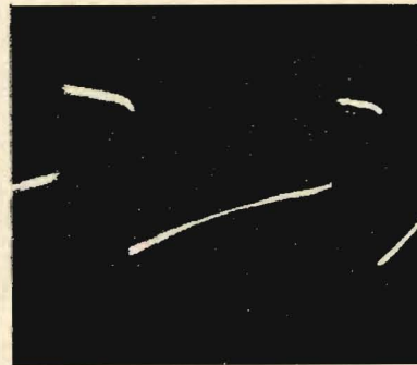
Fig. 4. - Onda prodotta dal multivibratore di figura 3.
